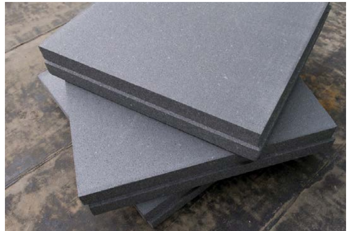
Die erste Dämmlage besteht aus Flachdachdämmplatten aus Neopor®. Die Platten haben einen umlaufenden Stufenfalz und können passgenau zusammengefügt werden.
